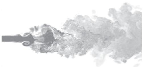
コンピュータシミュレーションにより再現された乱流。流れは左から右。噴流と呼ばれる、速い流れが空間中に噴出する流れの可視化。機械ではジェットエンジン背後の流れなど、自然現象では火山の噴火がつくる流れなどがこれに相当する。
