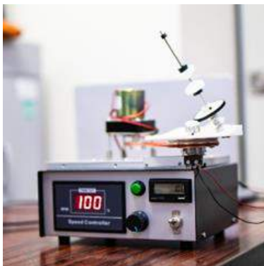
人工椎間板をつくるための実験機。 (実際の動きは紹介動画参照)
