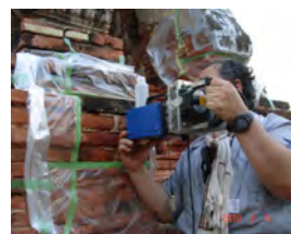
写真6 煉瓦の削孔試験
