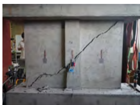
写真4 RC壁のせん断破壊実験
